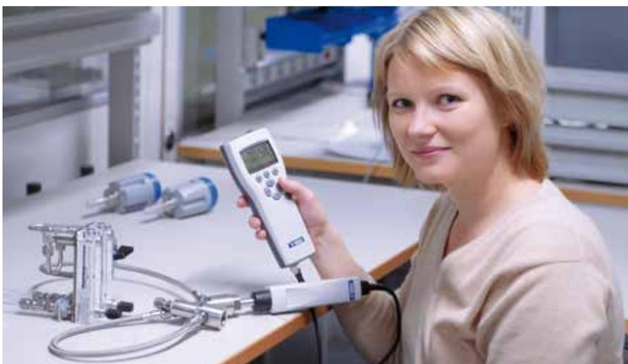
Les **instruments de mesure portables DM70** mesurent le point de rosée et la température avec précision sur une large plage de mesures. La sonde peut être insérée directement dans les processus sous pression jusqu'à 20 bars (290 psi) absolus et elle réagit rapidement, que ce soit dans les conditions ambiantes ou dans celles du processus.
